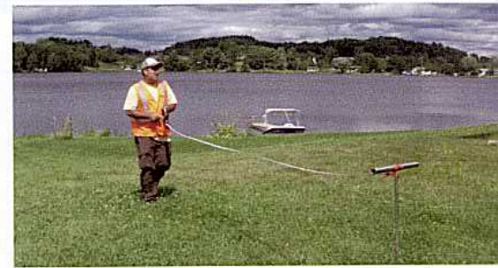
Mesure de la superficie disponible, de l'élévation du terrain et sondage stratigraphique
